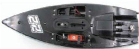
Rumpf montiert mit Servos und Batteriehalter
