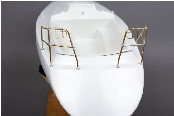
Abb. Heckkörbe mit Haltern für Rettungswesten
