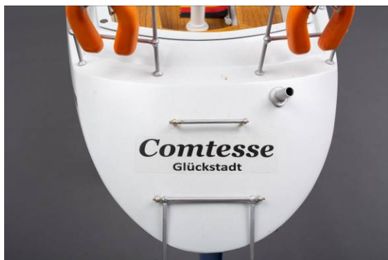
Vue: échelle descendue, barreau supplémentaire
