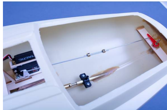
Abb. Verbindung Servo und Ruder
