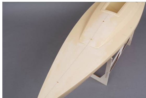
Abb. Bohrungen im Deck
