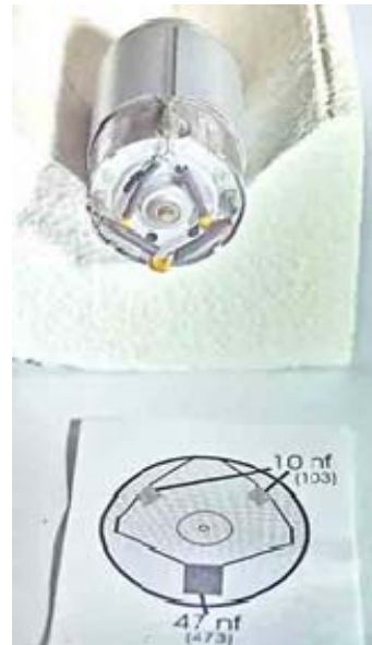
Abb. Motor entstören
