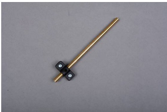
Abb. Schmiernippel mit dem Stevenrohr
