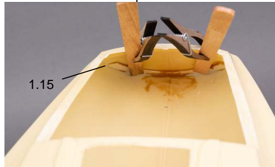
Vue: renfort arrière de coque
