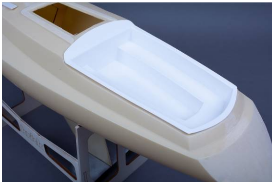
Abb. Plicht im Rumpf eingepasst
