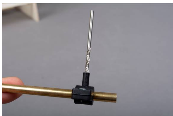
Vue: percez le trou de graissage dans le tube
