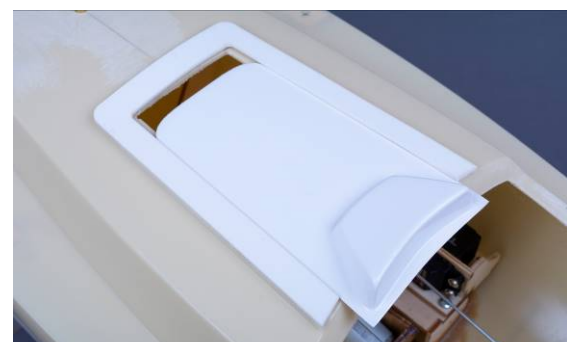
Abb. Rahmen verklebt, Schiebeluk einpassen
